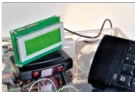
Bild 3: Das „Bedienelement“ des MP3-Players – IR-Numpad und der dazugehörige Empfänger, darauf das LCD-Display
