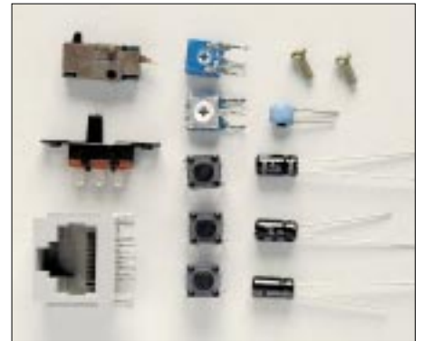
Bild 3: Außer der SMD-bestückten Platine enthält der Umbausatz noch diese Teile, die mit einem kleinen Lötcolben selbst bestückt werden müssen.
