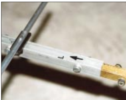
Verschraubung der Tragrohrhälften mittels zweier Messingstreifen
