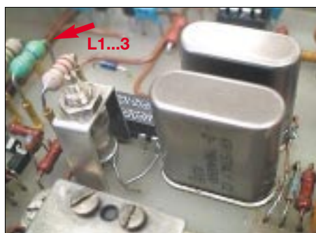
Bild 11: Detailansicht des Experimentalaufbaus mit den zwei Doppelquarzen, dem Reedrelais und dem Trimmer für konstanten RIT-Wert.
